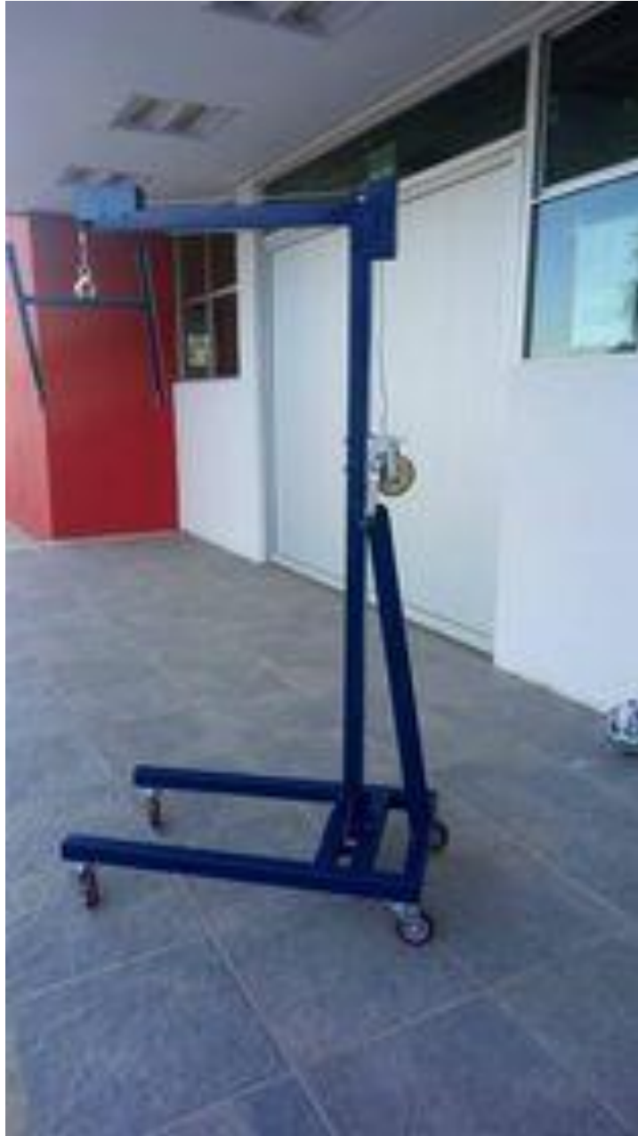
Fig. 26 Vehículo-grúa terminado. Fuente propia
